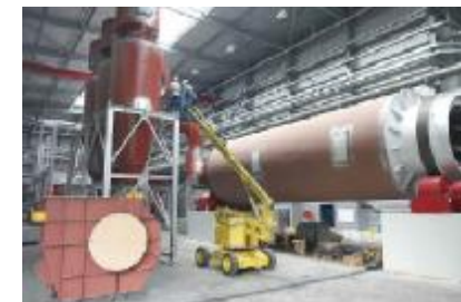
Drehende Trockentrommel (150 -300°C) Reduzierung auf 10% Wassergehalt
