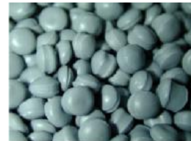
EBS 1: twarde pelety o wart. opalowej 14 -18 MJ/kg EBS 2: miękkie pelety EBS 3: paliwo RDF-fluff
