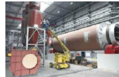
obrotowy bęben do suszenia (150 -300°C) redukcja zawartości wody do 10%
